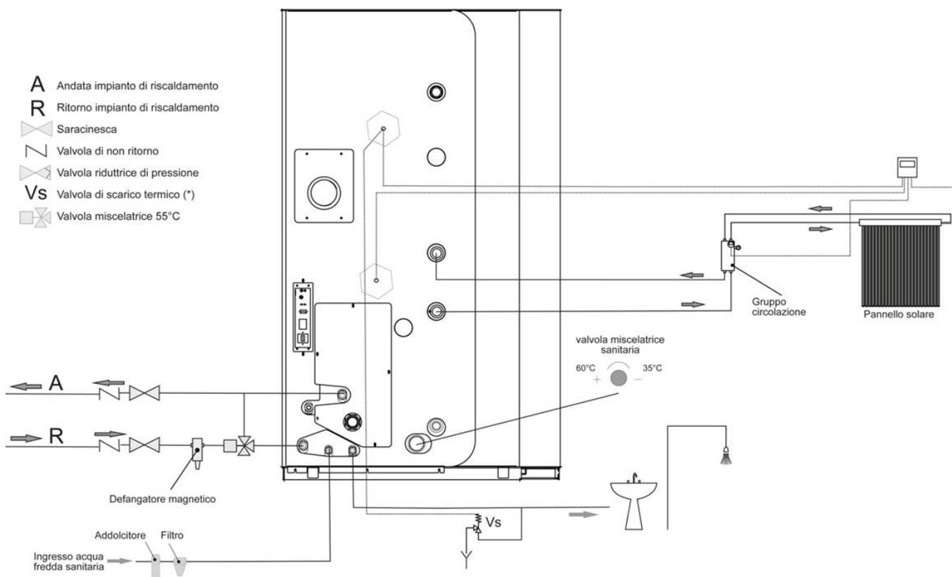
(\*) Valvola di scarico termico necessaria solo per i modelli SOLA
