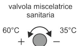
**Nella parte posteriore della caldaia si può accedere alla manopola della valvola miscelatrice per regolare la temperatura dell'acqua calda in uscita (vedi fig. 14.)**
