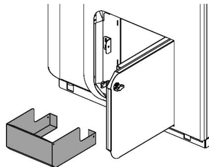
*Una modesta quantità di pellet incombusto all'interno del cassetto cenere non indica necessariamente un malfunzionamento della macchina ma può essere dovuta alle caratteristiche del combustibile.*
