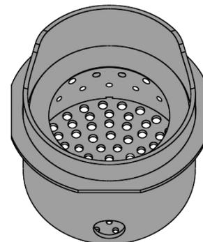
**ATTENZIONE: prima di accendere la caldaia, controllare che il braciere sia spinto indietro verso il deflettore e il tubo della candela di accensione sia inserito nel corrispondente foro del braciere.**
